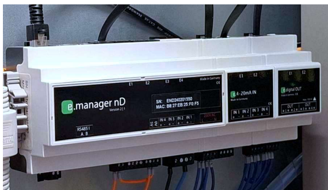
Bild 2.2: Direktvermarkter-Gateway in der NSUV BHKW
